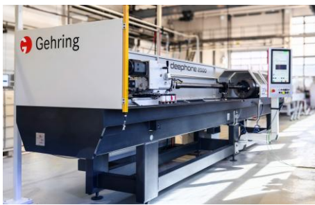
BU: Gearing Deephone 2000: Horizontale Honmaschine für große Durchmesser von 20 bis 600 mm, ausgelegt auf hohe Abtragsleistung, thermisch stabile Prozesse und eine durchgängige Qualitätsüberwachung durch integrierte In-Prozess-Messtechnik Bild: Gearing Technologies
